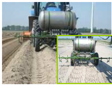
GS-NTS in pootaardappelen. Rijenspuit en direct infrezen
