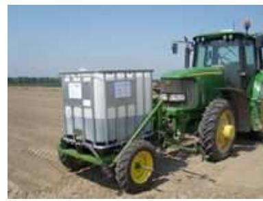
Vernieuwde toepassingstechniek! Transportcontainer direct op werktuig.
